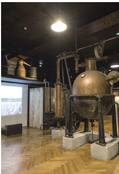
(写真上) 水蒸気蒸留法の機械。ラベンダーやバラのエッセンスを抽出するために使われた(写真下)博物館の入り口。1800年代につくられた建物で、劇場、自転車練習場、高級家具店を経て、香水博物館になった
